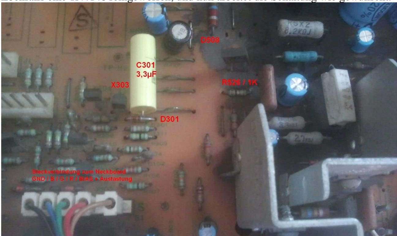
Also der zeitgleiche Defekt beider Dioden, die eigentlich nur der Klemmung und der Schwellenerkennung dienen, hat letztendlich zum Desaster geführt.
